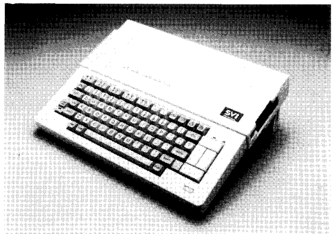
Spectravideo X'Press met ingebouwde 3,5" drive.
